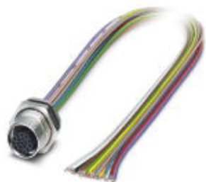
传感器/执行器孔式插座，17芯，M12 SPEEDCON，板后/M16螺纹安装，带0.5m无卤素TPE绞线，17 x 0.14 mm 2
