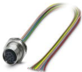
传感器/执行器孔式插座，8芯，M12 SPEEDCON，板后/M16螺纹安装，带0.5 m TPE绞线，8 x0.25 mm 2
