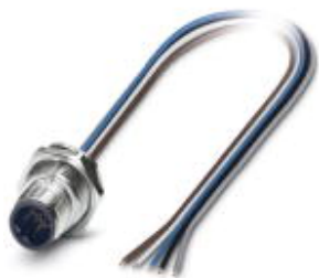
传感器/执行器插座，5芯，M12 SPEEDCON，B编码，板后/M16螺纹安装，带0.5 m TPE绞线，5 x 0.34 mm²
