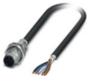
插座，屏蔽，5芯，M12，A编码，板后/M16螺纹安装，带1 m电缆，5 x .34 mm 2
