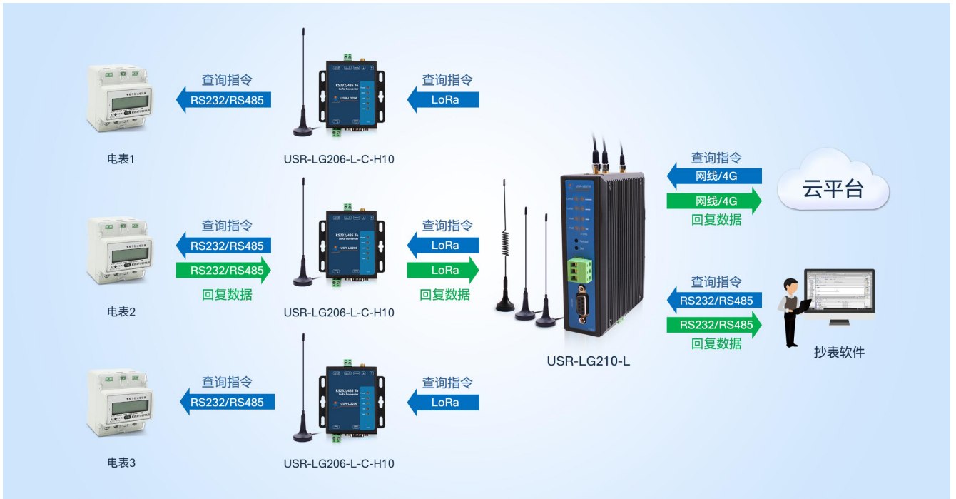
图 2.2 Modbus 抄表系统示意图
