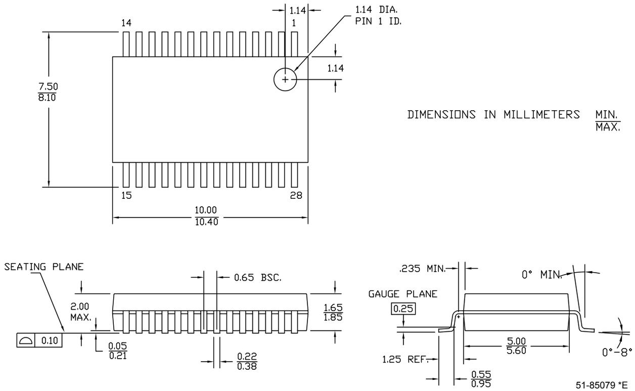
**Figure 21. 28-Pin (300-Mil) SOIC**
