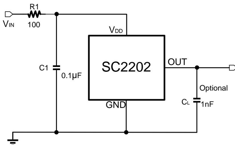
SC2202 内部有电压调节器，可以在宽供电电压范围内工作。当器件工作于非稳压电源供电的应用时，必须在外部添加瞬态保护。对于使用稳压电源线路供电的应用，可能仍然需要 EMI/RFI 保护。强烈建议电源端与接地端使用外接电容，可降低外部噪声及内部斩波频率技术产生的噪声，建议靠近芯片 V<sub>DD</sub> 电源端并联 C<sub>1</sub> 电容到地，其典型值为 0.1μF。同时在外部可选配串联电阻 R<sub>1</sub> 其典型值为 100Ω。输出电容 C<sub>L</sub> 用作输出滤波，典型值为 1nF。
