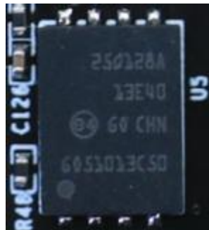
图 2-5-2 QSPI FLASH 部分实物图
