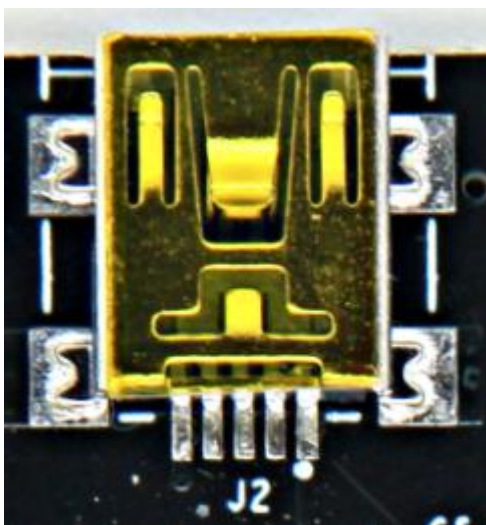
图 2-8-2 MINI USB 接口实物图
