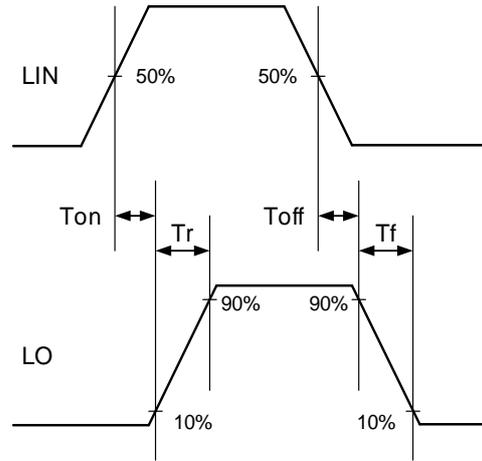
低边输出 LOx 开关时间波形图
