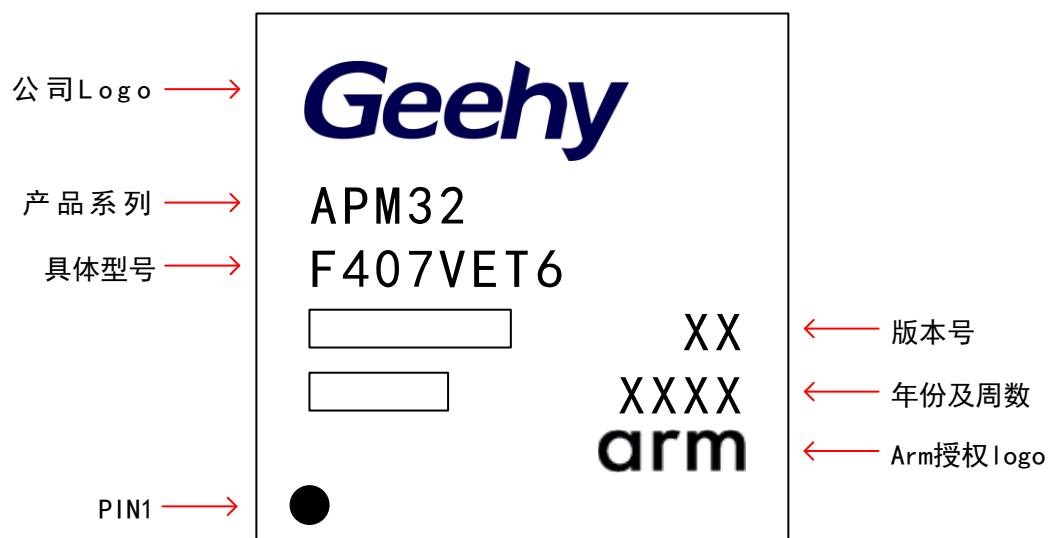
图 24 LQFP100 - 100 引脚，14 x 14mm 示意图
