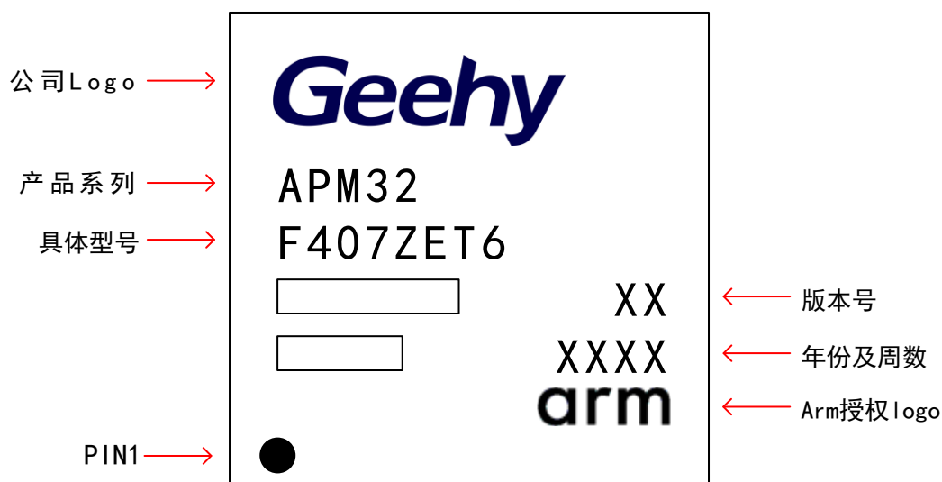
图 21 LQFP144 -144 引脚，20 x20mm 示意图
