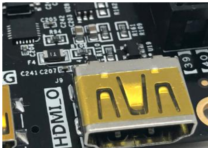
图 7-4 HDMI 接口的实物图
