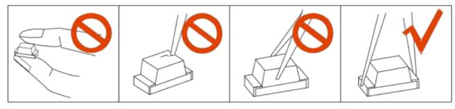
LED 的环氧树脂封装部分相当脆弱,请勿用坚硬、尖锐的物体刮、擦封装树脂部分。在用镊子夹取的时候也应当小心注意。
