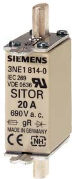
SITOR FUSE-LINK UTILIZ. CATEGORY GS, DIN 43620 20A , AC 690 V ,(SIZE 000)
