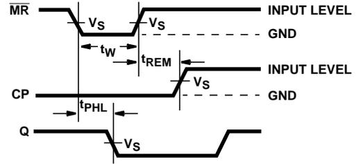
FIGURE 2. MASTER RESET PREREQUISITE TIMES AND PROPAGATION DELAYS
