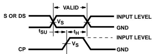
FIGURE 4. PARALLEL LOAD OR SHIFT-LEFT/SHIFT-RIGHT PREREQUISITE TIMES
