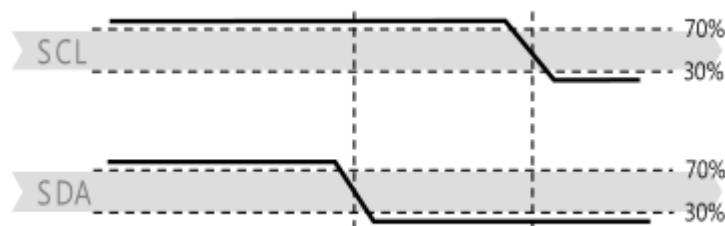
图18 启动传输状态 (S) -当SCL为高电平时, SDA由高电平转换为低电平。开始状态是由主机控制的一种特殊的总线状态, 指示从机传输开始 (Start之后, BUS总线一般被认为处于占线状态)
