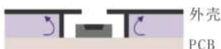
图12：传感器与外壳内部空气进行隔离，将外壳内部密闭空气对传感器的影响降到最低。
