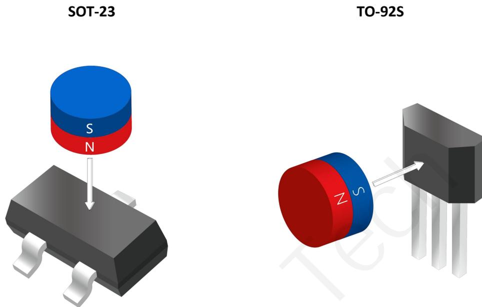
如上图，HX3144 产品对磁感线由芯片底部垂直向芯片顶部穿过的磁场和由芯片顶部垂直向芯片底部穿过的磁场都敏感。以丝印面为正面，HX3144，SOT-23 封装对 N 极磁场敏感；TO-92S 封装对 S 极磁场敏感。
